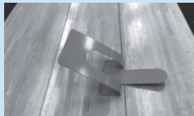
書架振動の衝撃により曲がった、スチール製ブックエンド
